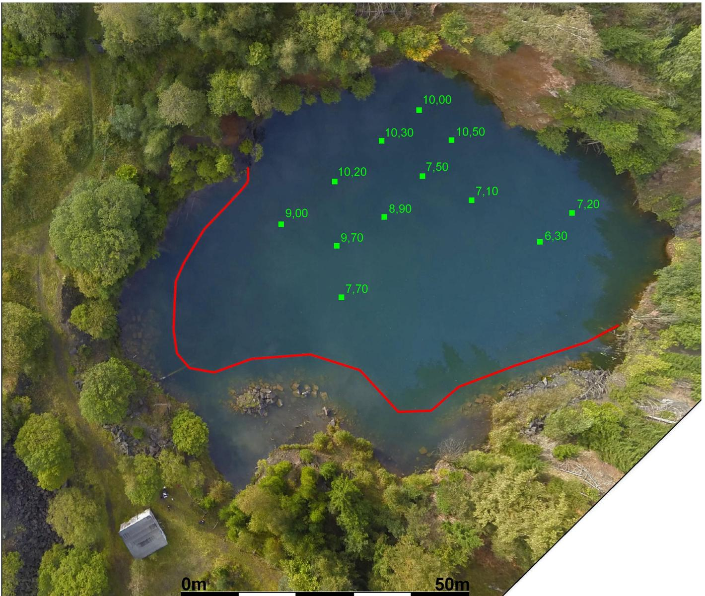
Abbildung 5: Darstellung der begehbaren Bereiche (bis zur roten Linie) des Versuchsgewässers. In diesem Bereich wurden die Reusen vom Uferbereich aus ohne Hilfe eines Bootes gestellt. Die grünen Zahlen zeigen die gemessene Tiefe an der jeweiligen Stelle in Meter an. Die Daten der Tiefenmessung in dieser Abbildung wurden am 18.02.2015 erhoben und stehen exemplarisch für die Struktur des Gewässers.
